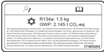
15 Potentiel de réchauffement de la planète (PRP), équivalent CO 2
